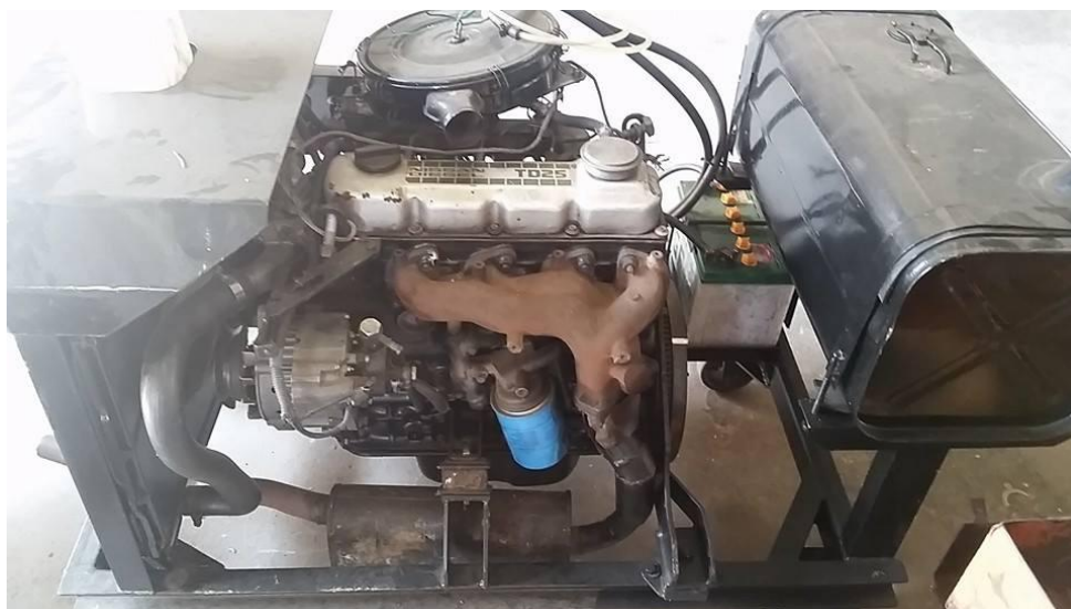
รูปที่ 20 เครื่องยนต์ดีเซล 4 สูบ ยี่ห้อ Nissan Diesel TD 25
